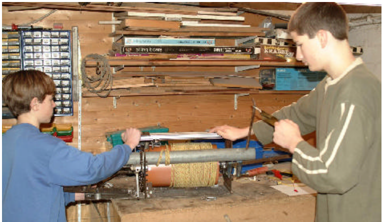
Abb. 7: Einstellung der Bremsmechanik auf 1400 N
