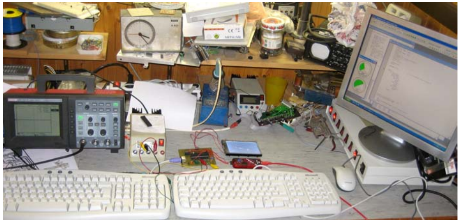
Abb. 12: Messaufbau zur praktischen Erprobung des Gerätes. Mitte von links: Oszilloskop, Netzteil, Platine, Display unten von links: Tastatur für den PIC und den PC, PC-Monitor
