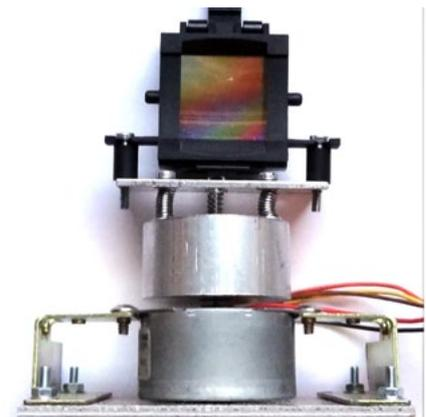
Abb. 4: Gitter in Halterung (oben), darunter einstellbare Plattform, darunter Schrittmotor montiert auf einer weiteren Plattform
