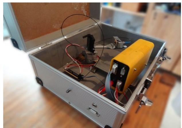
Abb. 8: Komplettes Spektrometer im Koffer-Gehäuse
