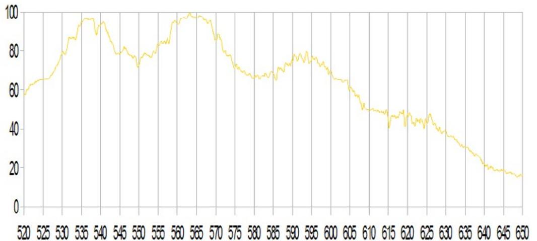
Abb. 31: Kalibriertes Emissionsspektrum einer weißen LED. x-Achse in nm, y-Achse in rel Intensität. Mittelwertbildung von 7 Messungen, gleitender Durchschnitt 5 Messwerte.
