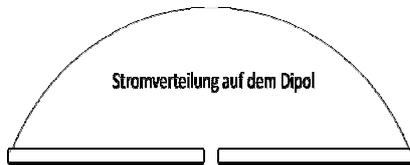
Abb. 3 Stromverteilung auf einem  $\lambda_0/2$  Dipol
