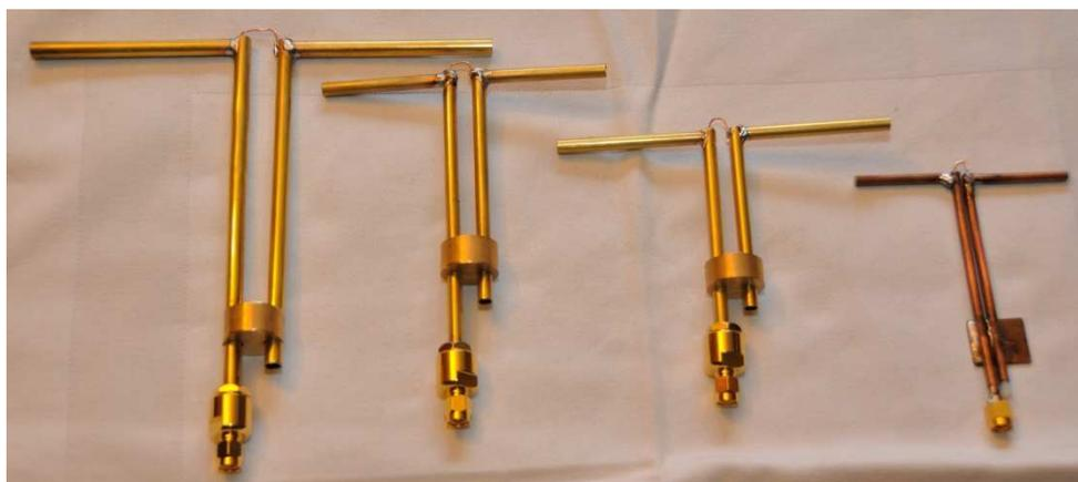
Abb. zu Tabelle 1: Abbildung unserer selbst gebauten Dipole
